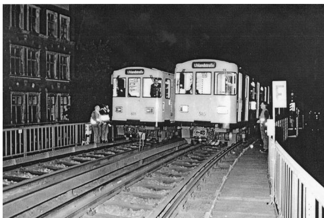
**Bild 3.** Belastungsversuch mit zwei leeren U-Bahnzügen während der nächtlichen Betriebspause
