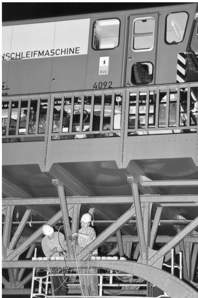
**Bild 10.** Vorbereitung einer radiographischen Aufnahme am Fachwerkknoten mit Belastungszug zur größtmöglichen Riffnung whrend der Aufnahme
