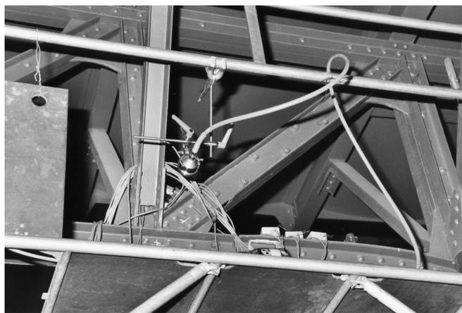
**Bild 11.** Durchstrahlung eines Knotenblechs, ausgerichteter Strahlenschutzkopf mit Strahlenquelle fr die radiographische Aufnahme
