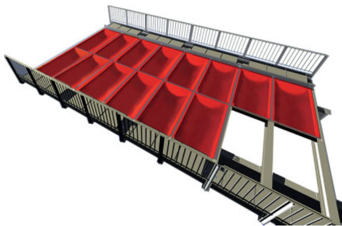
Bild 7. Variante 3: Nachbau „homöopathisch verbesserter“ Buckelbleche (Visualisierung Lorenz & Co. Bauingenieure) Fig. 7. Option 3: Replacement of buckled plates 'homoeopathically' changed in detail
